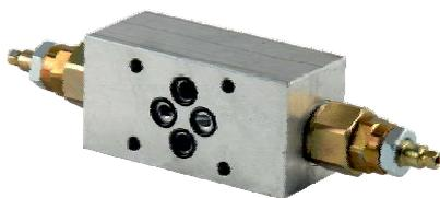
Modulare Zwischenplatten NG6 als Druck- und Stromventile. Die Zwischenplattengehäuse sind aus Aluminium. Die hier verwendeten Einschraubventile sind baugleich mit denen im Zentralflansch.
