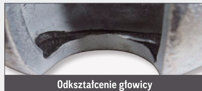
Pęknięcie w głowicy
