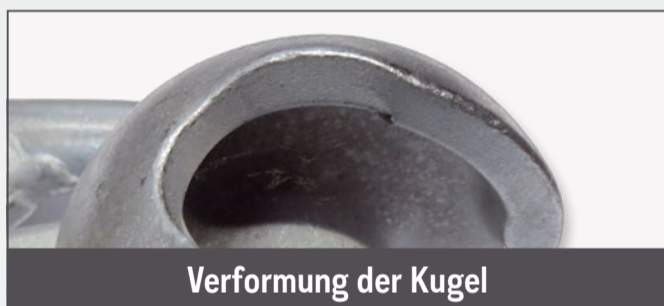
Druckstellen durch Anschlagmittel
